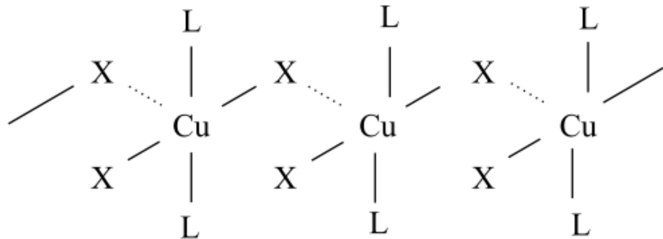
*Рис. 2.* Схема формирования галогенидных мостиков в полимерной структуре комплексов  $\text{CuL}_2\text{X}_2$ .
