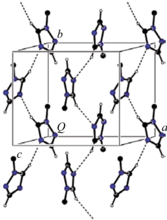
Рис. 5. Упаковка в полиэдре кристаллического 1-*tert*-бутил-1,2,4-триазола.
