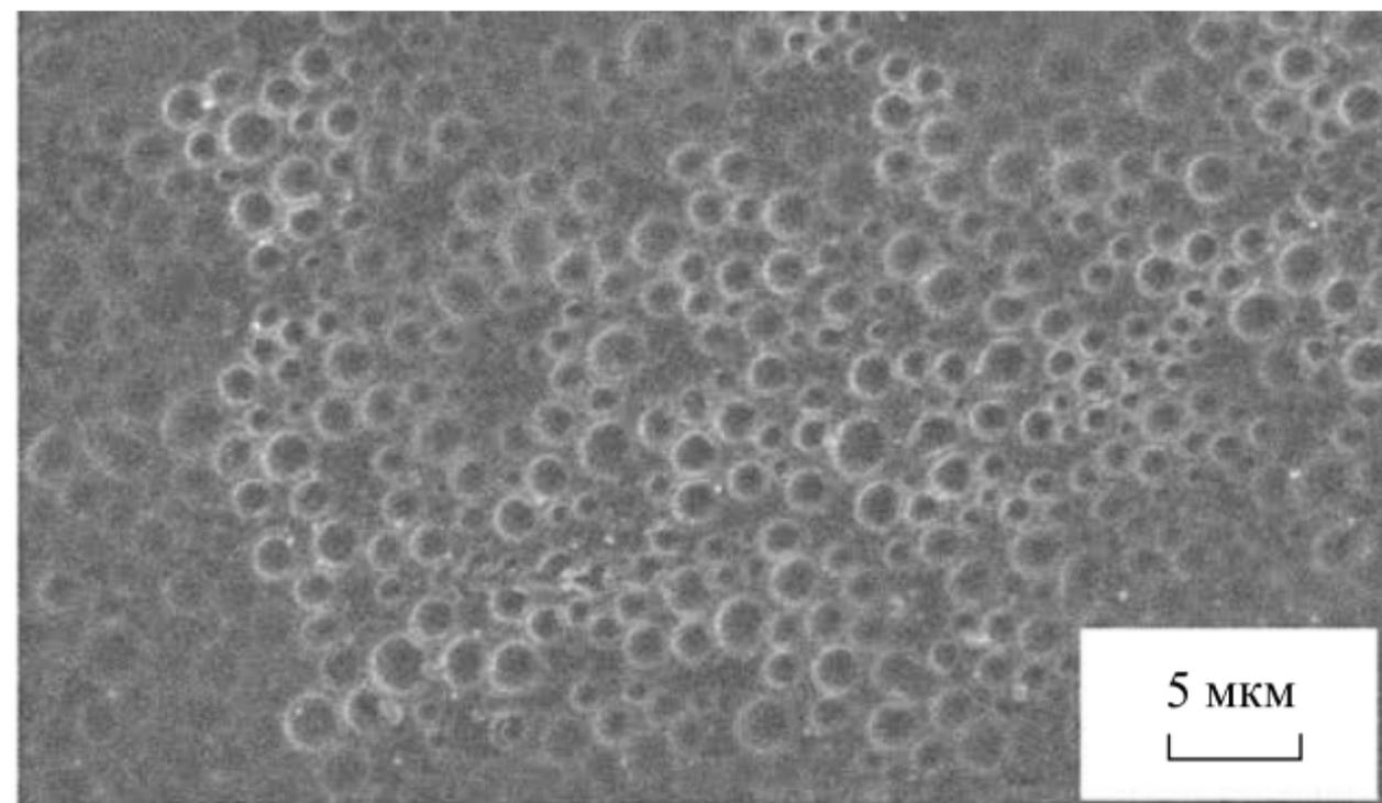
*Рис. 8. СЭМ-изображения поверхности пленок поли(ИБ-блок-D,L-Ла);
