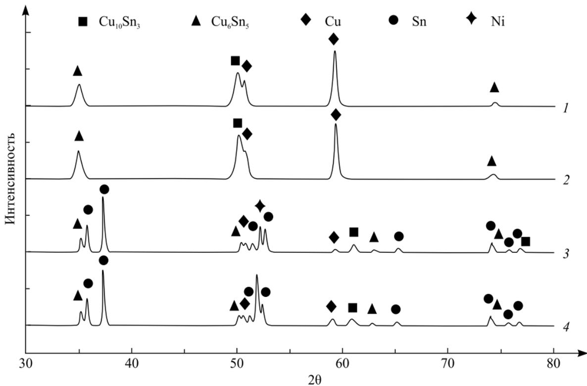
Рис. 3. Рентгенограммы сплавов Cu–Sn:
