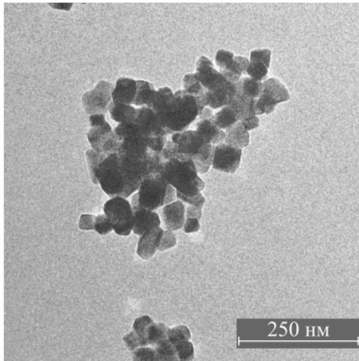
*Рис. 2.* ПЭМ-изображения наночастиц  $\text{Co}_{0,65}\text{Zn}_{0,35}\text{Fe}_2\text{O}_4$  до обжига (*а*) и после обжига при  $900\text{ }^\circ\text{C}$  и отмывки (*б*)
