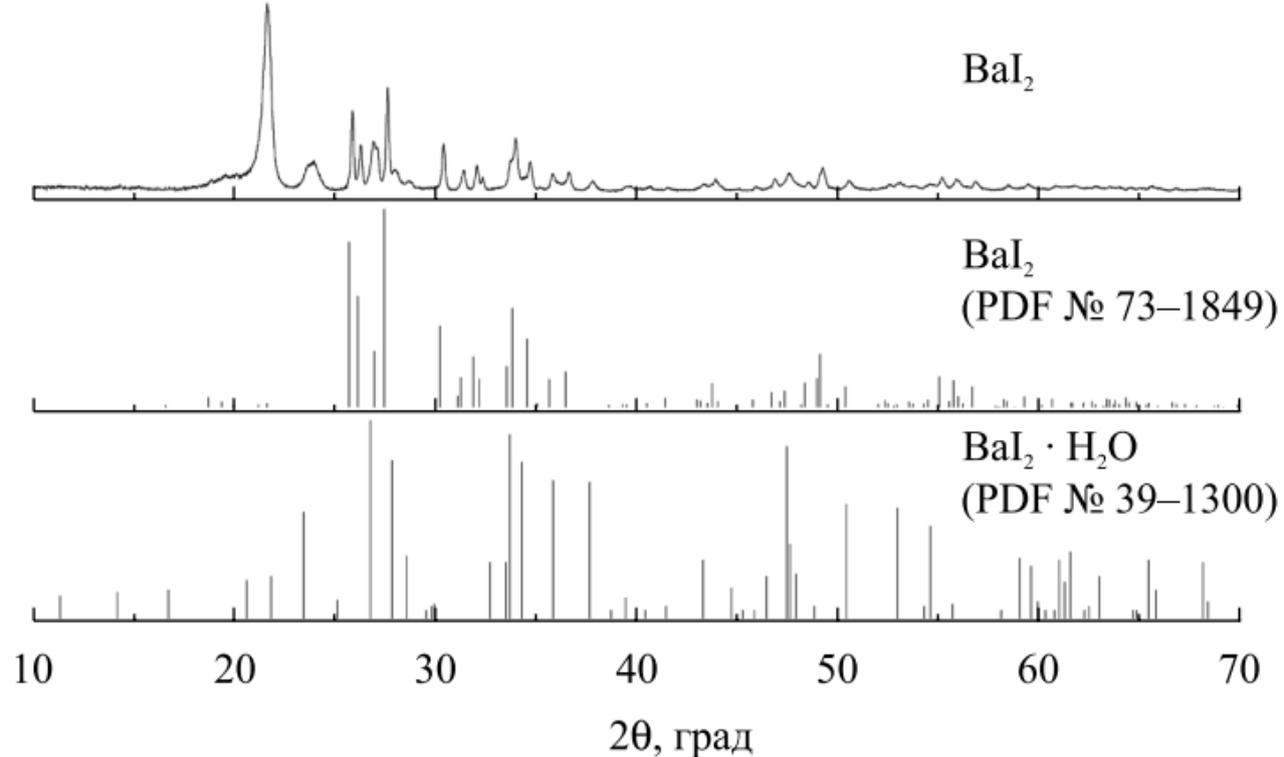
*Рис. 1.* Рентгенограмма порошка  $\text{BaI}_2$ . Уширенные рефлекссы с максимумами при  $21,5^\circ$  и  $23,8^\circ$  относятся к полиэтиленовой пленке
