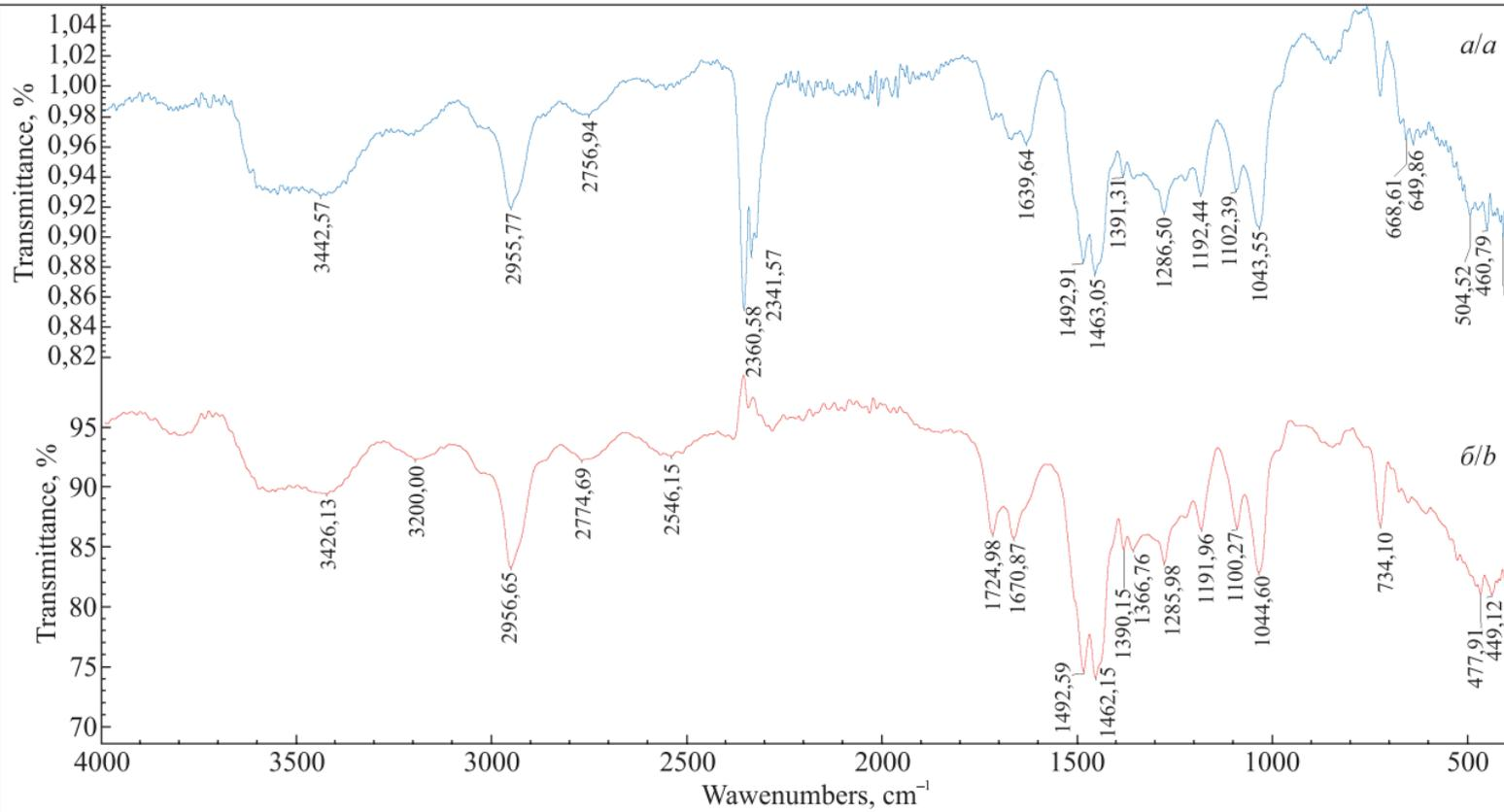
ИК-спектры образцов МПВТ, полученных одностадийным методом с отгонкой воды из реакционной смеси (без выделения ПВТ) (а) и в две стадии (с выделением ПВТ) (б)
