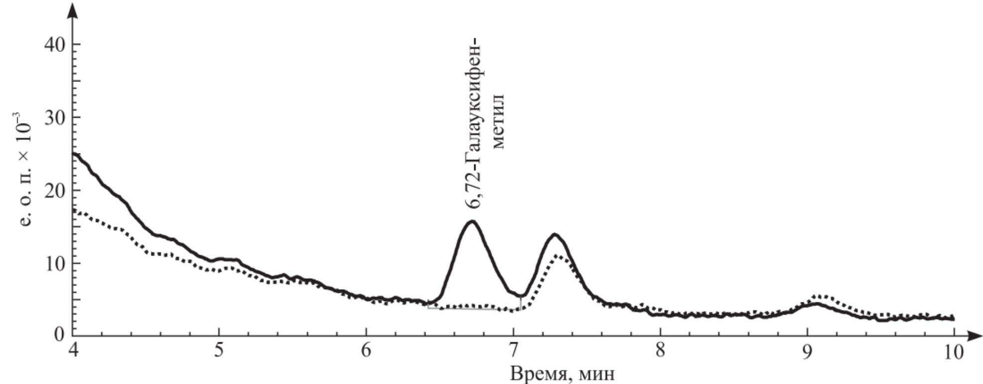
Рис. 3. Наложенные хроматограммы образцов зерна ячменя без добавки (пунктирная линия) и с добавкой 0,04 мг/кг галауксифен-метила (сплошная линия), подготовленные по разработанной методике
