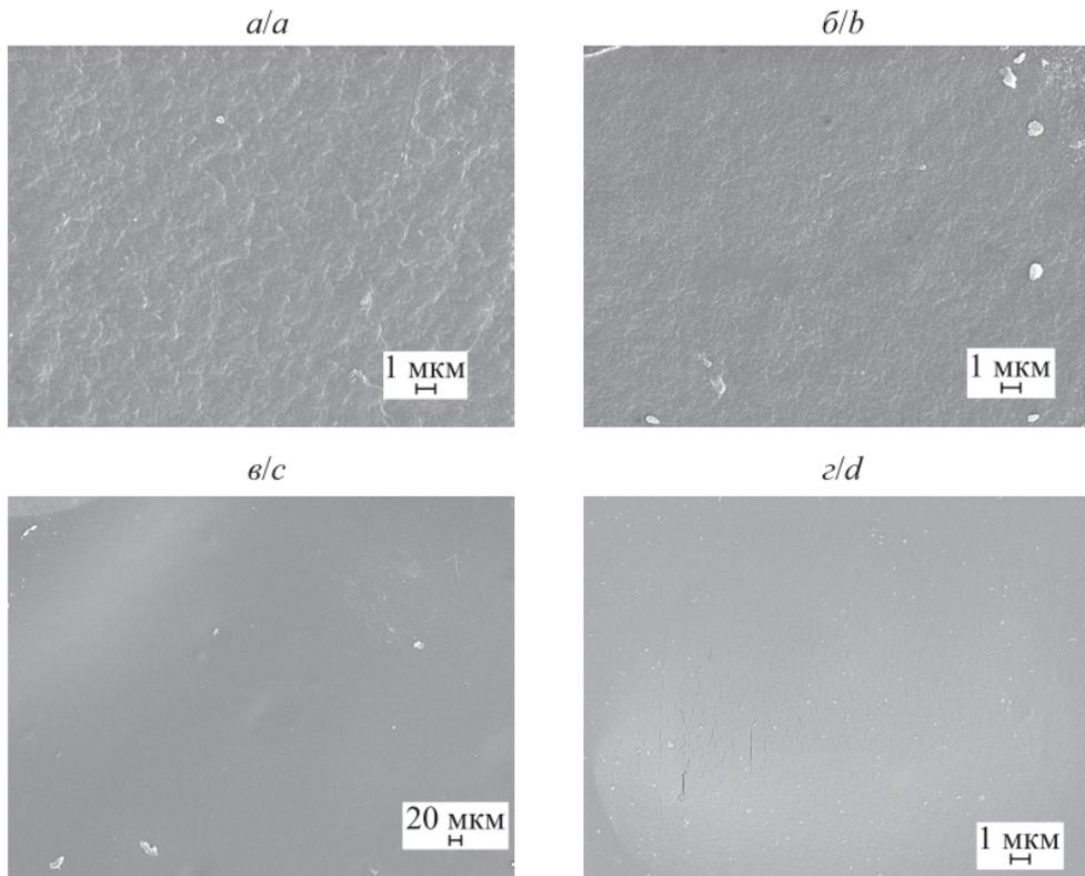
*Рис. 2.* СЭМ-фотографии поверхности мембран без подложки из раствора целлюлозы (а), из раствора смеси целлюлозы и ХТЗ (80 : 20) (б); двухслойной пленки целлюлоза/ХТЗ (в); целлофана (г).
