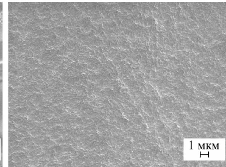
*Рис. 4. СЭМ-фотографии поверхности вискозной ткани (а) и целлюлозной мембрany, сформованной на вискозной ткани (б, в). Время выдержки раствора на ткани 15 мин.
