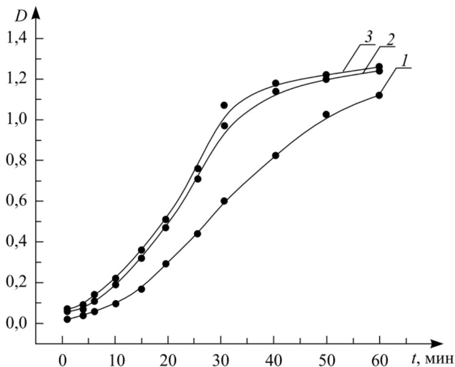
*Рис. 4.* Зависимость максимальной оптической плотности золей золота от времени синтеза при разных значениях концентрации  $\text{Na}_2\text{ЭДТА}$ : 1 –  $2,5 \cdot 10^{-4}$  моль/л; 2 –  $5 \cdot 10^{-4}$  моль/л; 3 –  $10^{-3}$  моль/л. Во всех случаях  $[\text{HAuCl}_4] = 5 \cdot 10^{-4}$  моль/л, pH 12,0
