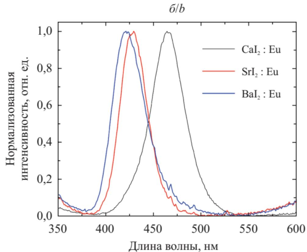
Рис. 3. СВЛ (а) и СЛ (б) ( $\lambda_{\text{возб}} = 320$  нм) образцов  $\text{MI}_2 : \text{Eu}^{2+}$
