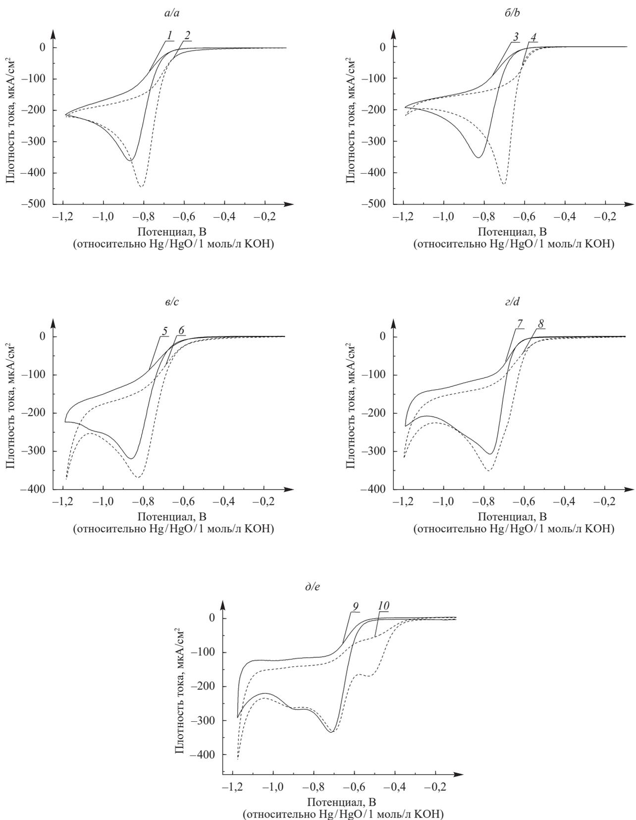
Рис. 4. ЦВА-кривые для исходных электродов  $\text{TiO}_2$  (1, 3, 5, 7, 9) и после их модифицирования НЧ Au (2, 4, 6, 8, 10), измеренные в насыщенном кислородом растворе 0,1 моль/л KOH: а – термическая пленка; б – гидrolитическая пленка; в – УЗ-пленка; г – золь-гель пленка; д – анодная пленка, состоящая из упорядоченных нанотрубок  $\text{TiO}_2$
