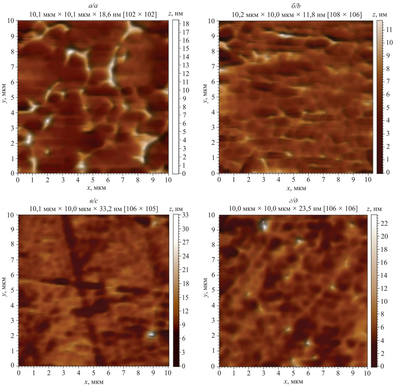
*Рис. 2.* АСМ-структура пленок ПММА, сформированных на гидрофилизированных кремниевых пластинах (*a, б*) и предметных стеклах (*в, г*) из растворов с концентрацией 0,5 мг/мл (*a, в*) и 1 мг/мл (*б, г*) методом полива
