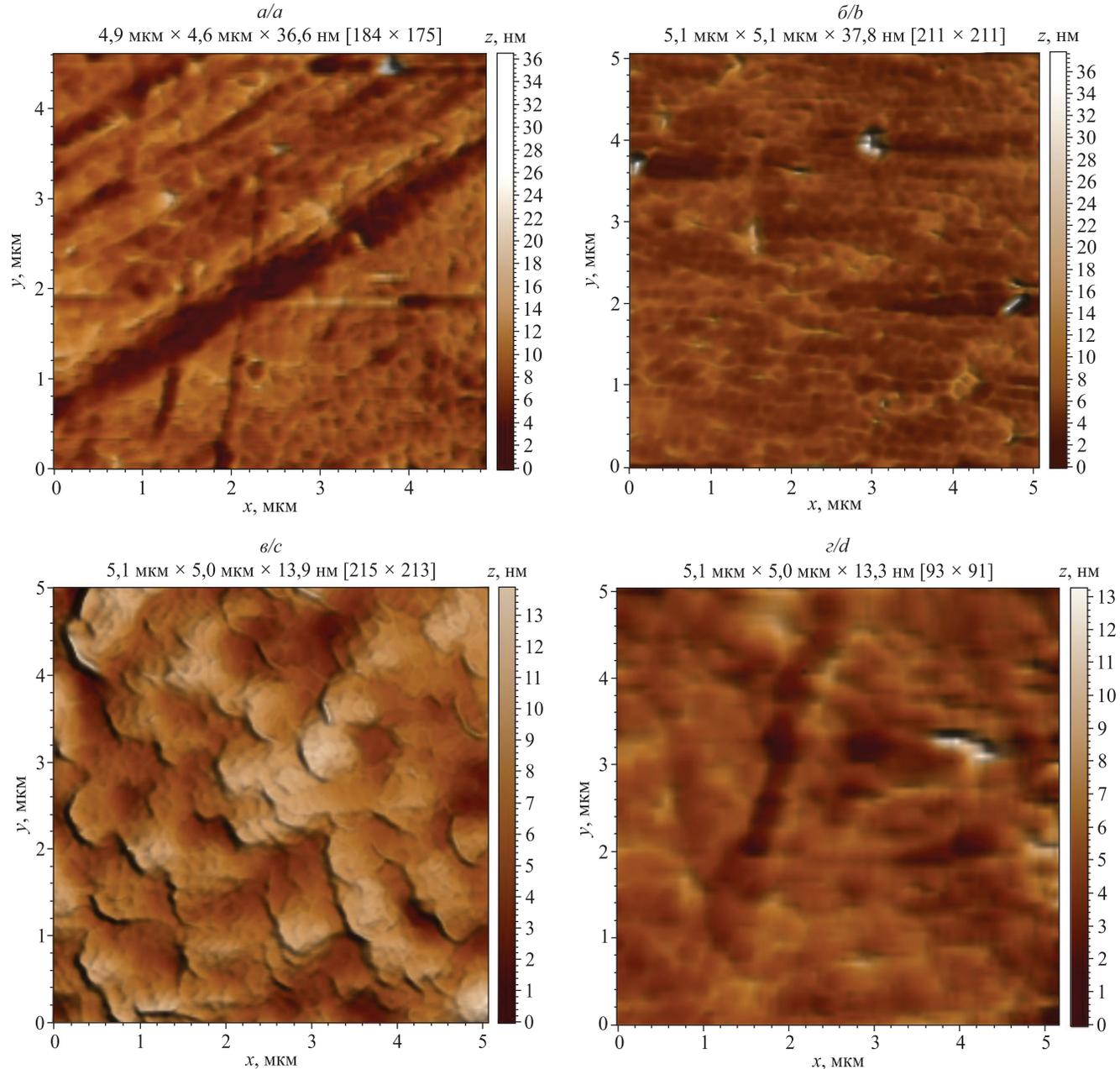
Рис. 5. Структура композиционных пленок ПММА с наночастицами диоксида кремния, сформированных методом спин-коутинга на гидрофилизованных стеклянных подложках из суспензий с различным соотношением ПММА и SiO<sub>2</sub>, моль: 1 : 1,67 · 10<sup>2</sup> (а); 1 : 3,3 · 10<sup>2</sup> (б); 1 : 5,0 · 10<sup>2</sup> (в); 1 : 6,7 · 10<sup>2</sup> (г)
