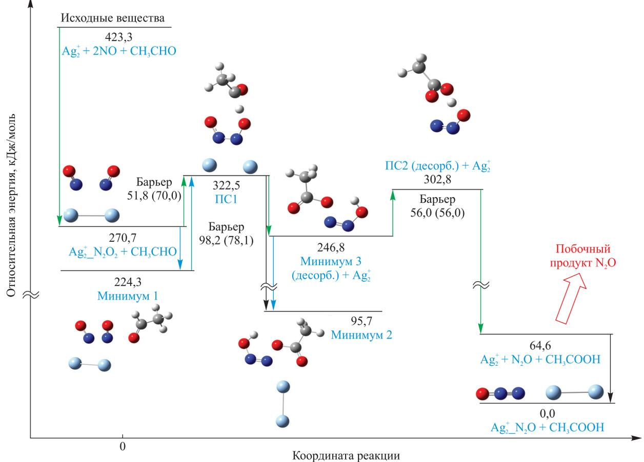
Рис. 3. Энергетическая диаграмма реакции образования  $\text{N}_2\text{O}$  в случае катализаторов с высоким содержанием серебра на примере каталитических центров  $\text{Ag}_2^+$ . В скобках указаны величины барьеров аналогичных процессов на каталитических центрах  $\text{Ag}_2$ .
