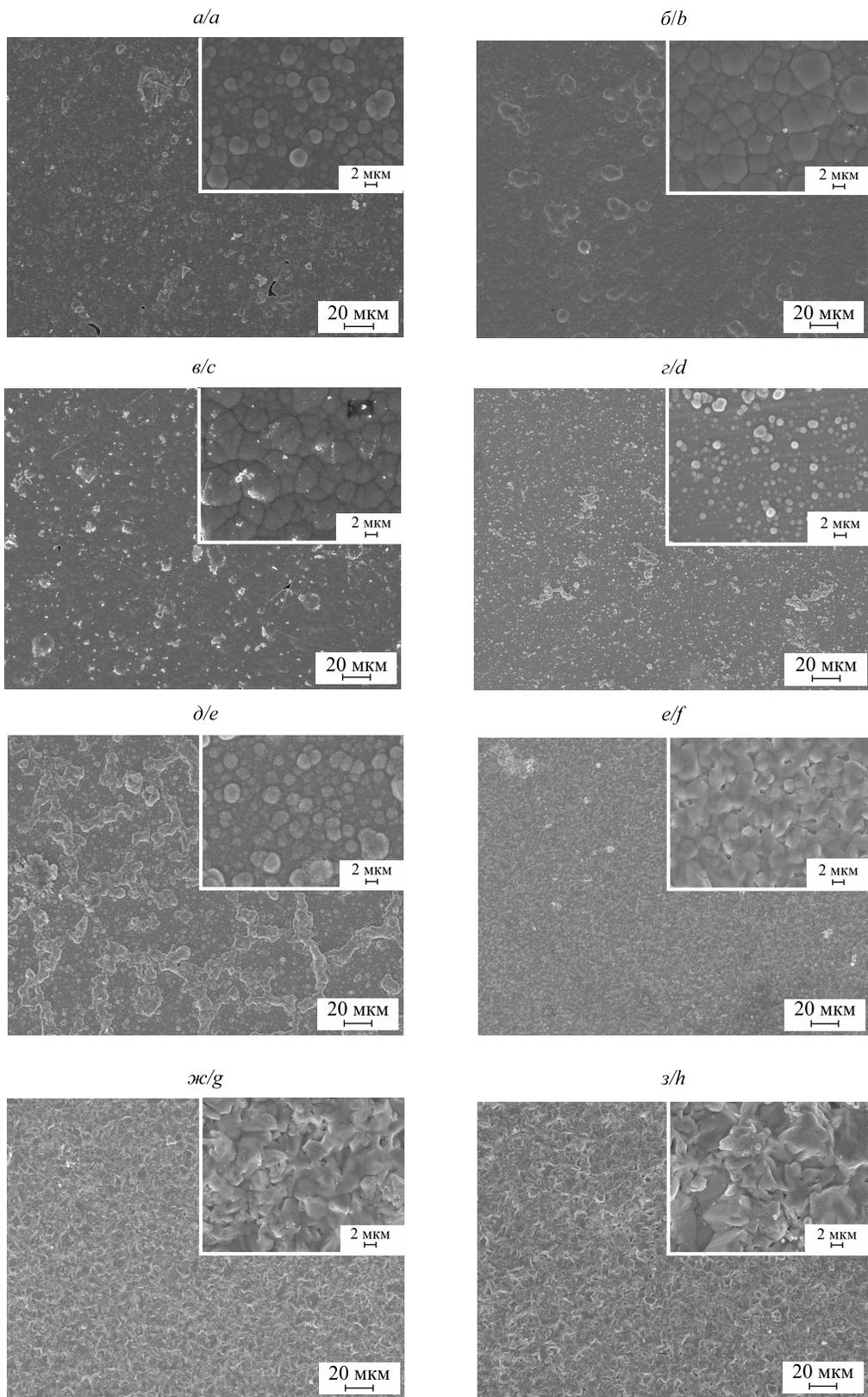
*Рис. 1.* СЭМ-фотографии поверхности покрытий Ni – Sn толщиной 1 мкм (а, з, е), 5 мкм (б, д, ж) и 10 мкм (в, з), осаждаемых из хлоридно-фторидных электролитов № 1 (а – в), № 2 (з, д) и № 3 (е – з) при плотности тока 0,5 А/дм<sup>2</sup>
