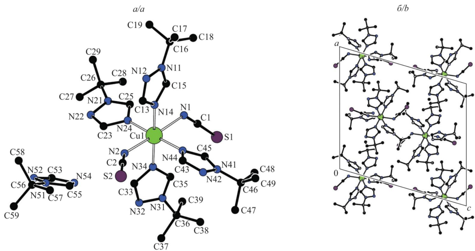
Рис. 5. Молекула комплекса и некоординированная молекула лиганда в структуре  $[Cu(NCS)_2L_4] \cdot L$  (a) и проекция кристаллической структуры вдоль оси  $b$  ( $\bar{b}$ ) (атомы водорода не показаны)
