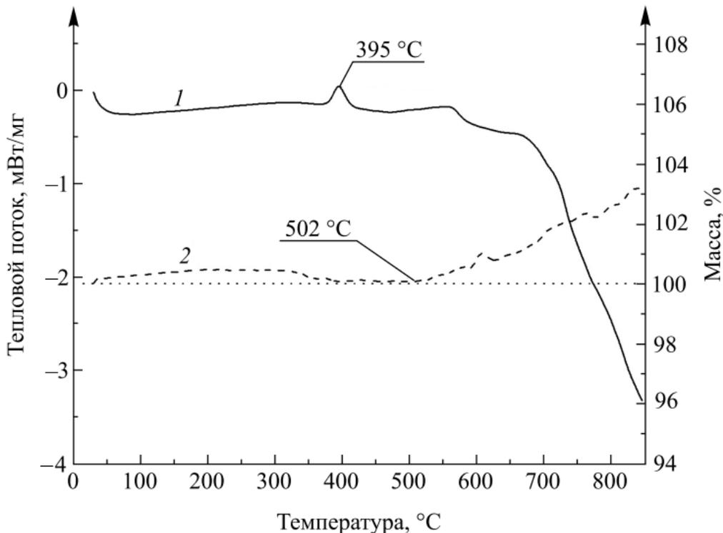
Рис. 4. Кривые дифференциальной сканирующей калориметрии (1) и термогравиметрии (2), полученные для покрытия никель – бор, осажденного из электролита, содержащего 0,1 г/л декагидро-κлозо-декабората натрия
