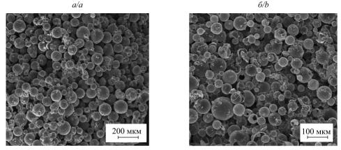
$Puc.\ 2.\ CЭМ$ -изображение поверхности (a) и бокового скола  $(\delta)$  композита, полученного на основе твердого МФС с зольными (a) и стеклянными  $(\delta)$  ПМС  $Fig.\ 2.\ SEM$  images of the surface (a) and side split (b) of the prepared composite based on solid magnesium phosphate binder with fly-ash (a) and glass (b) hollow microspheres
