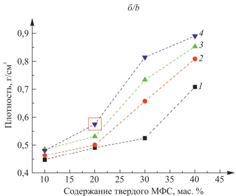
*Рис. 3.* Зависимость прочности (*a*) и плотности (*б*) композитов с зольными ПМС от содержания твердого МФС и основного наполнителя: 1 – 5 мас. %; 2 – 10 мас. %; 3 – 15 мас. %; 4 – 20 мас. %
