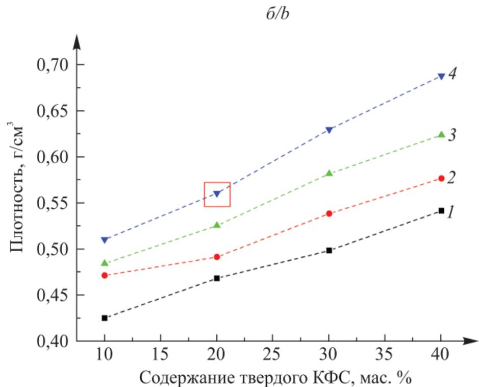
*Рис. 4.* Зависимость прочности (*a*) и плотности (*б*) композитов с зольными ПМС от содержания твердого КФС и основного наполнителя: 1 – 5 мас. %; 2 – 10 мас. %; 3 – 15 мас. %; 4 – 20 мас. %
