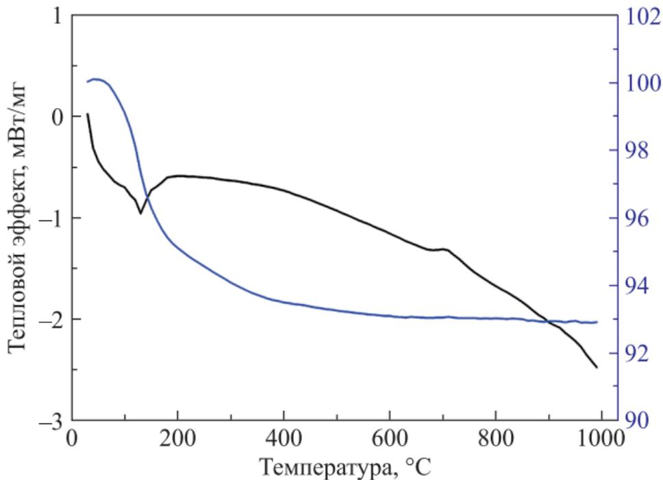
Рис. 5. Термограмма композита на основе твердого МФС и зольных ПМС
