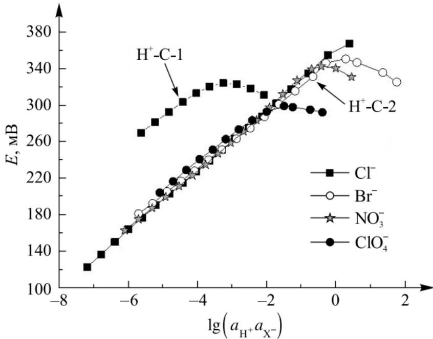
Рис. 1. Зависимость потенциала  $H^+$ -селективных электродов на основе ионофоров  $H^+-C-1$  (электрод сравнения – хлоридсеребряный электрод (3,5 моль/л KCl)) и  $H^+-C-2$  (электрод сравнения – хлоридсеребряный электрод (NaCl – Na<sub>2</sub>SO<sub>4</sub>)) от состава раствора. Ионообменник – КТХФБ
