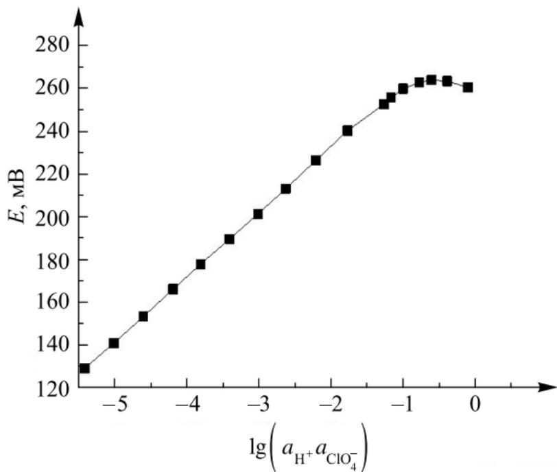
*Рис. 2.* Зависимость потенциала  $\text{H}^+$ -селективных электродов на основе композиции ионофора  $\text{H}^+$ -С-2 и ионообменника КТФФБ от логарифма произведения активностей ионов перхлората и водорода в равнопереносящей смеси
