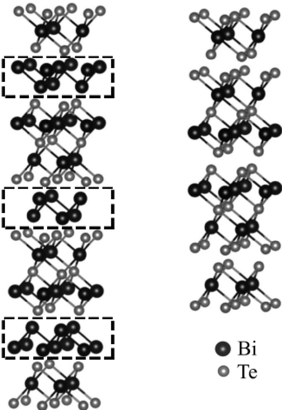
*Рис. 1.* Кристаллические структуры представителя сверхрешеток  $(\text{Bi}_2)_m(\text{Bi}_2\text{Te}_3)_n$  (*a*) и теллурида висмута  $\text{Bi}_2\text{Te}_3$  (*б*)
