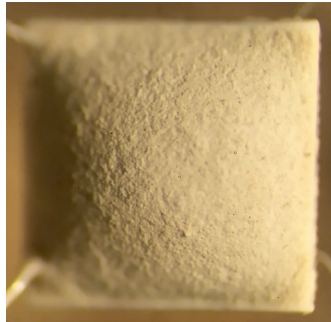
Рис. 2. Фотографические снимки сенсора (а) и чувствительных элементов на основе \text{SnO}_2 (б) и \text{In}_2\text{O}_3 (в)
