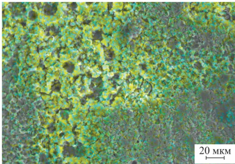
*Рис. 5.* Многослойная карта распределения элементов на поверхности образца магниевого сплава MA2-1 после последовательной обработки в растворах, содержащих 120 г/л  $\text{CrO}_3$  и 110 мл/л (63 %)  $\text{HNO}_3$ , и в растворе 55 мл/л (47 %)  $\text{HF}$
