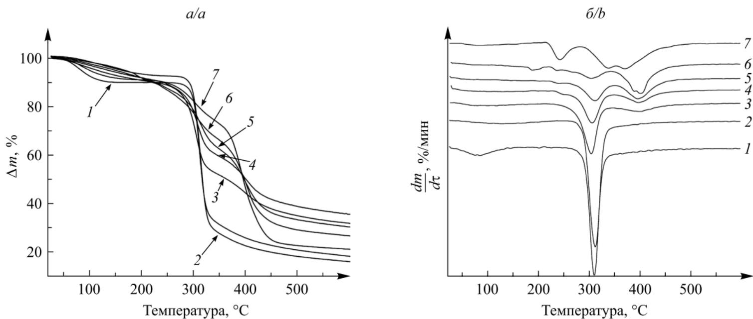
*Рис. 4.* Интегральные (а) и дифференциальные (б) термогравиметрические кривые индивидуального крахмала, ПАА и сополимеров крахмала с АА:
