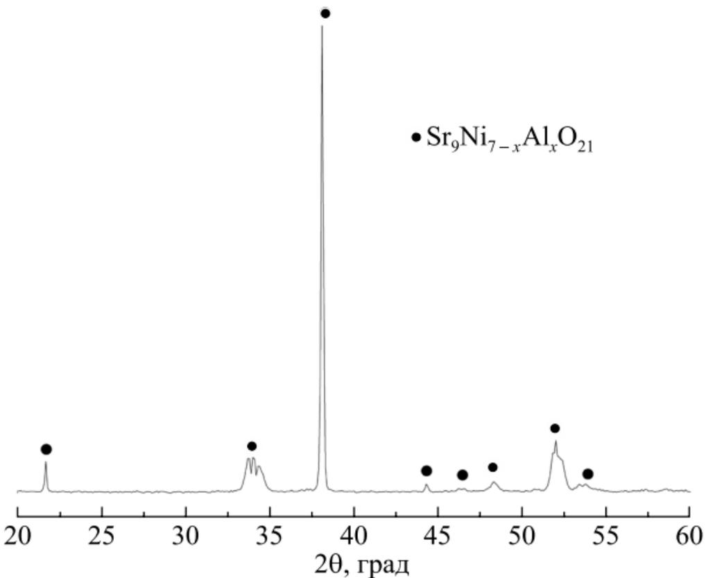
Рис. 7. Дифрактограмма образца  $\text{Sr}_9\text{Ni}_{6.8}\text{Al}_{0.2}\text{O}_{21}$
