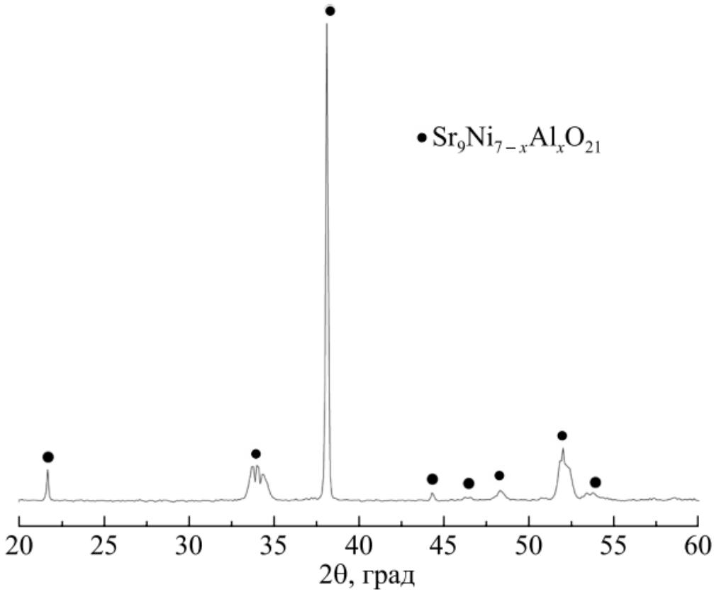
Рис. 7. Дифрактограмма образца  $\text{Sr}_9\text{Ni}_{6,8}\text{Al}_{0,2}\text{O}_{21}$
