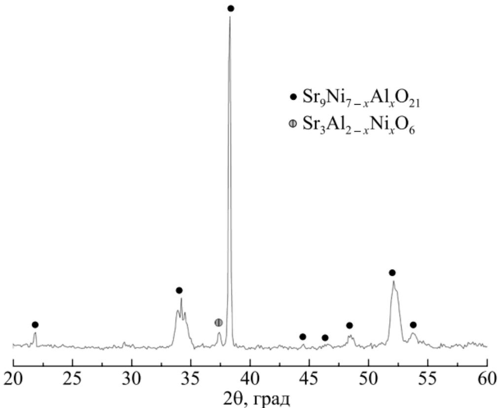
Рис. 9. Дифрактограмма образца  $\text{Sr}_9\text{Ni}_{6.5}\text{Al}_{0.5}\text{O}_{21}$
