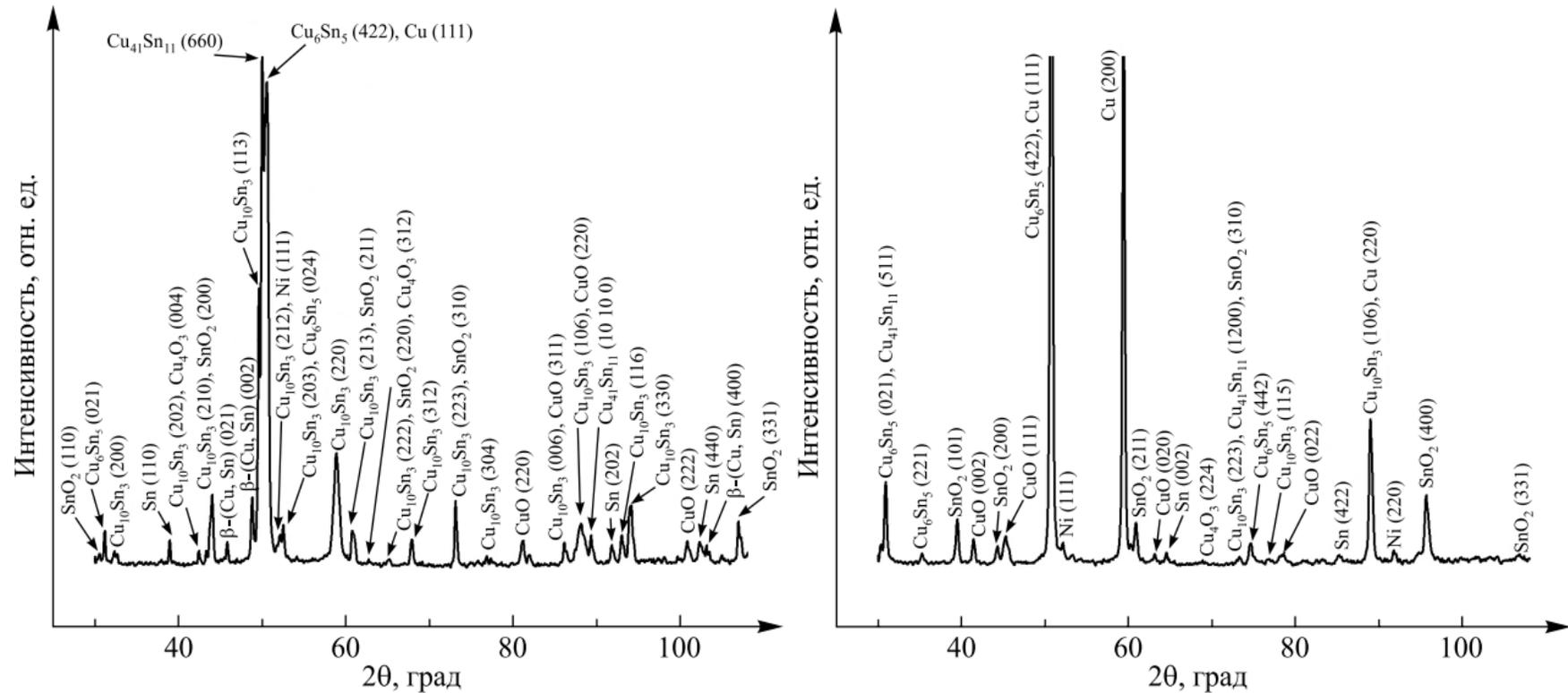
Рис. 2. Рентгенограммы покрытий Cu – Sn, прогретых при температуре 250 °C (а) и 400 °C (б) в течение 2 ч.
