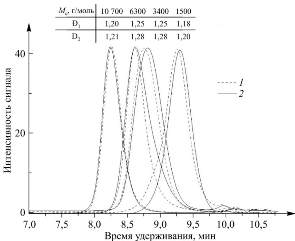
Рис. 7. Эксклюзионные хроматограммы (1 – до модификации, 2 – после модификации) ПИБ-ОН с различной молекулярной массой ( $\mathfrak{D}_1$  – полидисперсность до модификации,  $\mathfrak{D}_2$  – полидисперсность после модификации; время алкилирования – 2,5 ч)
