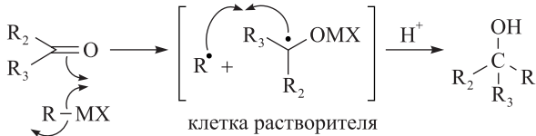
Рис. 1. Предполагаемые механизмы реакции Барбье
