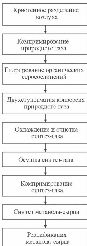
Рис. 4. Схема производства метанола технического на ОАО «Гродно Азот»
