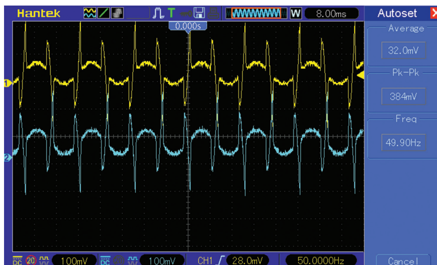
Рис. 3. Осциллограмма напряжения (1) и тока (2) при работе светодиодных прожекторов СДО-06
