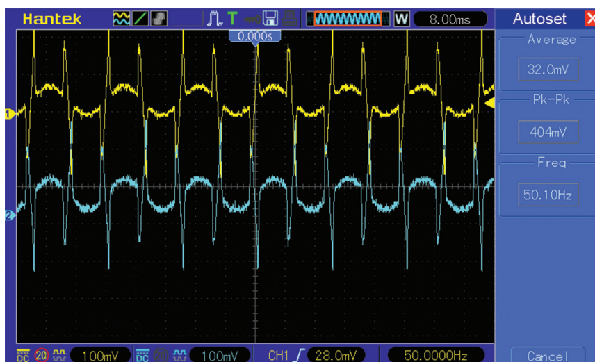
Рис. 2. Осциллограмма напряжения (1) и тока (2) при работе светодиодных лент при напряжении: а – 200 В; б – 225 В; в – 250 В
