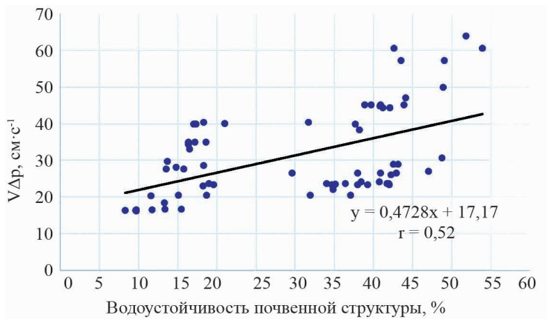
Рис. 1. Зависимость размывающей скоростью водного потока ( V_{\Delta p} ) от водоустойчивости макроструктуры почвы
