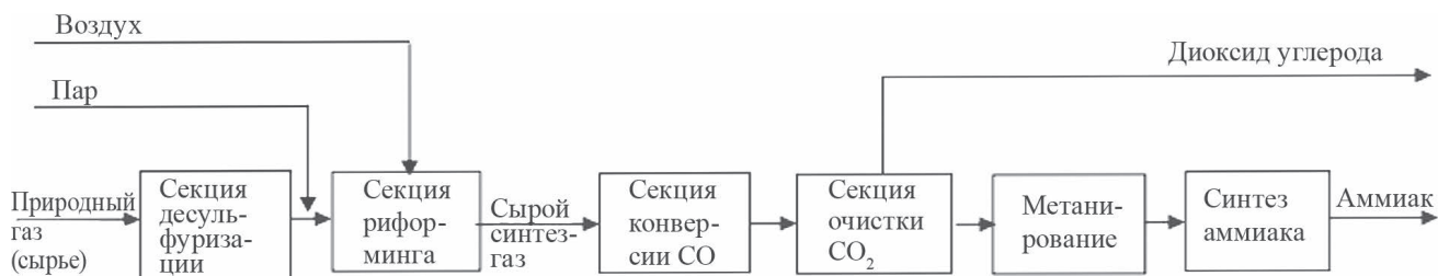
Рис. 2. Основные этапы производства аммиака
