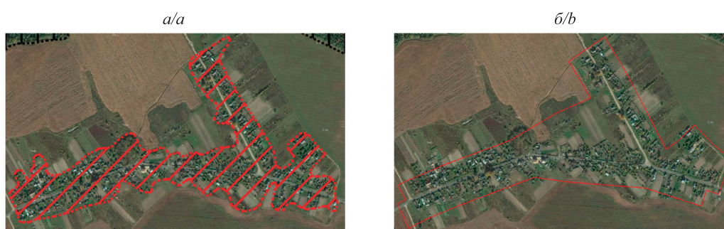
Рис. 8. Оцифровка контура населенного пункта: а – предложенная оцифровка, которая совпадает с труднопроходимой зоной, считываемой с ИКМ; б – оцифровка по существующим ПЦО
