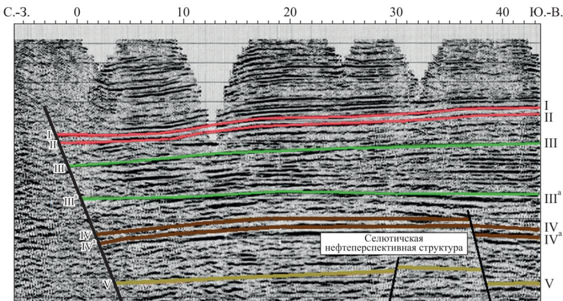
*Рис. 7.* Временной сейсмический разрез в пределах Селютичской нефтеперспективной структуры.
