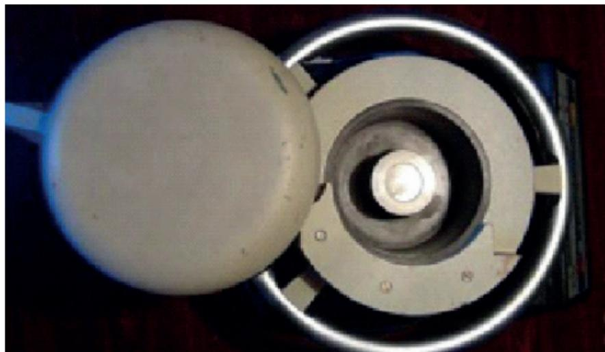
*Рис. 2.* Общий вид гамма-радиометра РУГ-91М «Адани» (а)
