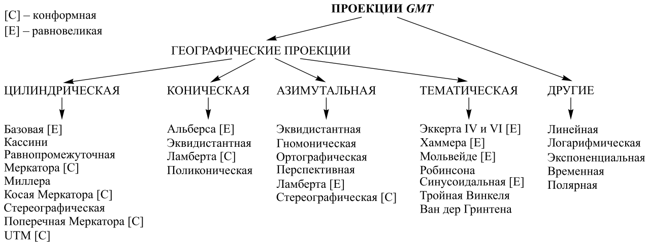
Рис. 2. Проекции, поддерживаемые программным пакетом GMT
