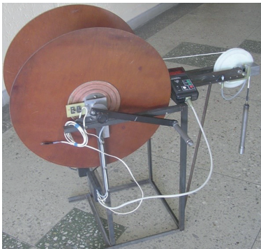
Рис. 2. Общий вид цифрового скважинного электротермометра (а) и процесс регистрации термограммы в скважине 966г, пробуренной в Солигорском районе Минской области (северо-западная часть Припятского прогиба) (б)
