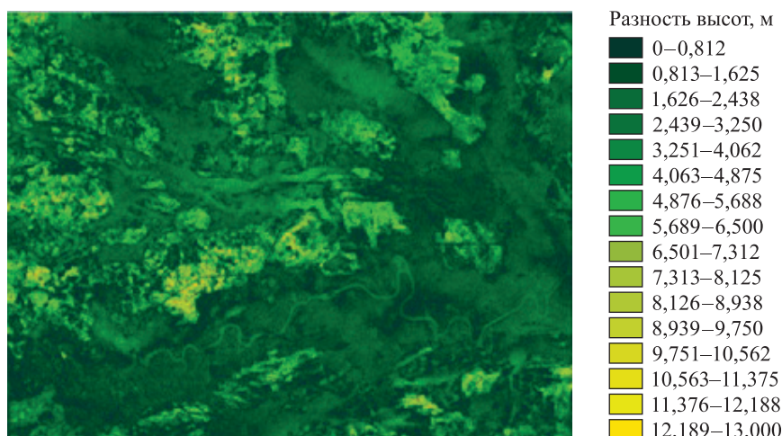
Рис. 5. Результат сравнения матриц, полученных по данным топографических карт масштаба 1 : 100 000 и данным SRTM
