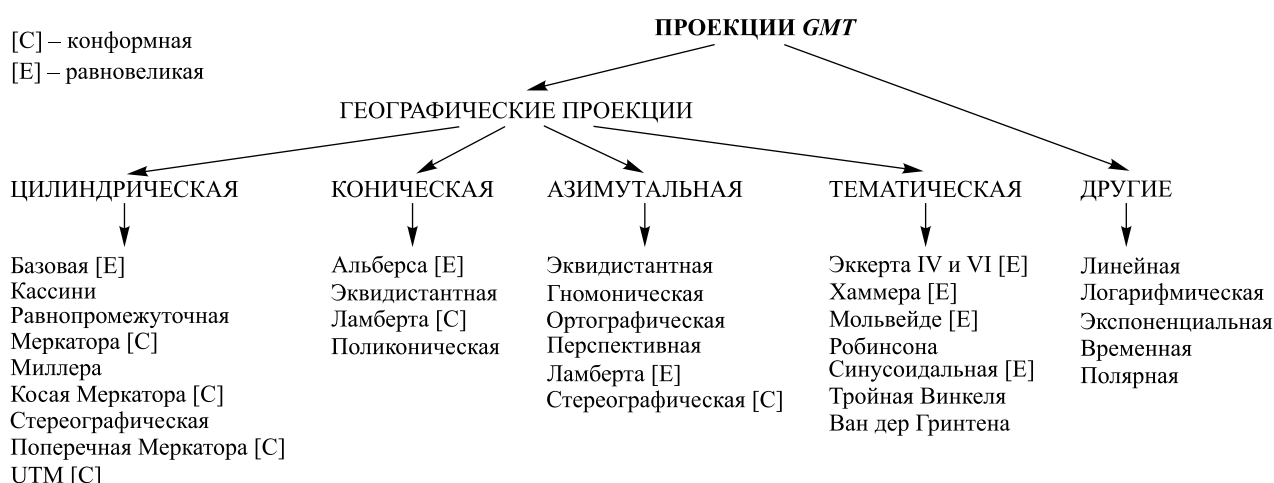
Рис. 2. Проекции, поддерживаемые программным пакетом GMT
