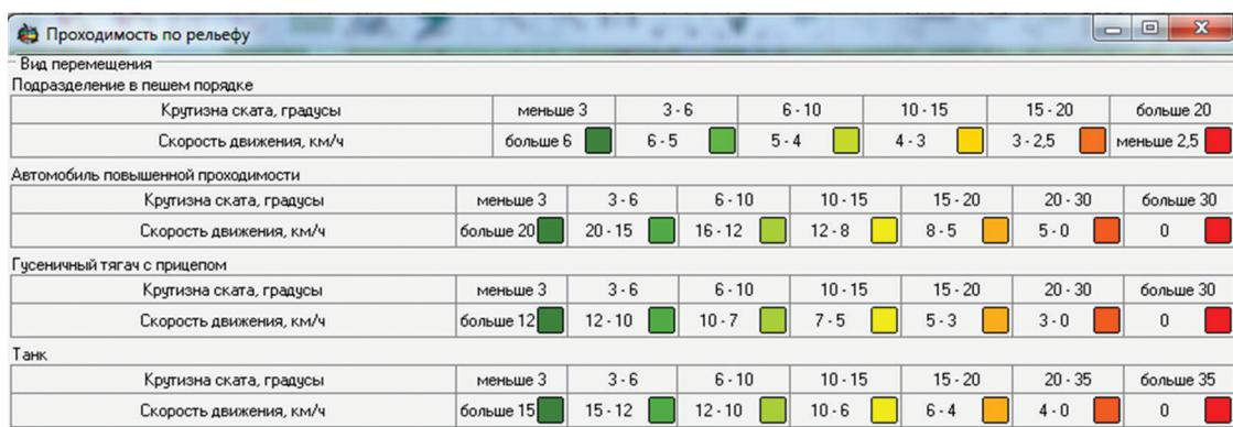
Рис. 4. Построение матрицы уклонов в режиме «проходимость по рельефу»
