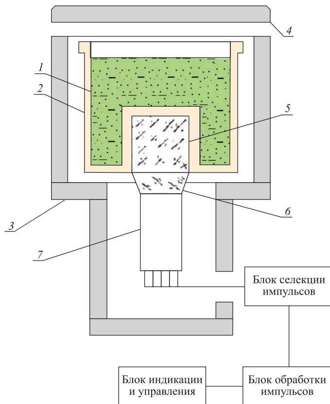
Рис. 3. Упрощенная функциональная схема гамма-радиометра РУГ-91М «Адани»:
