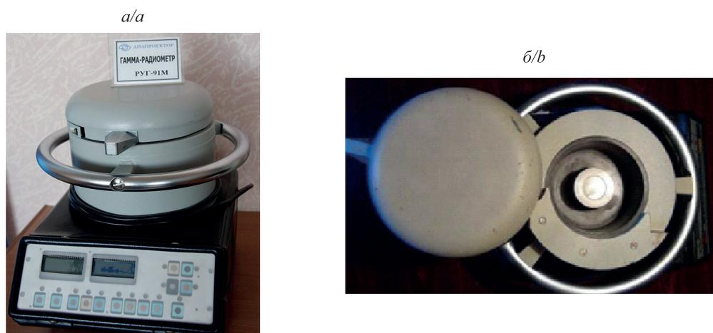
Рис. 2. Общий вид гамма-радиометра РУГ-91М «Адани» (а) и его внутренний вид при снятом сосуде Маринелли (б)
