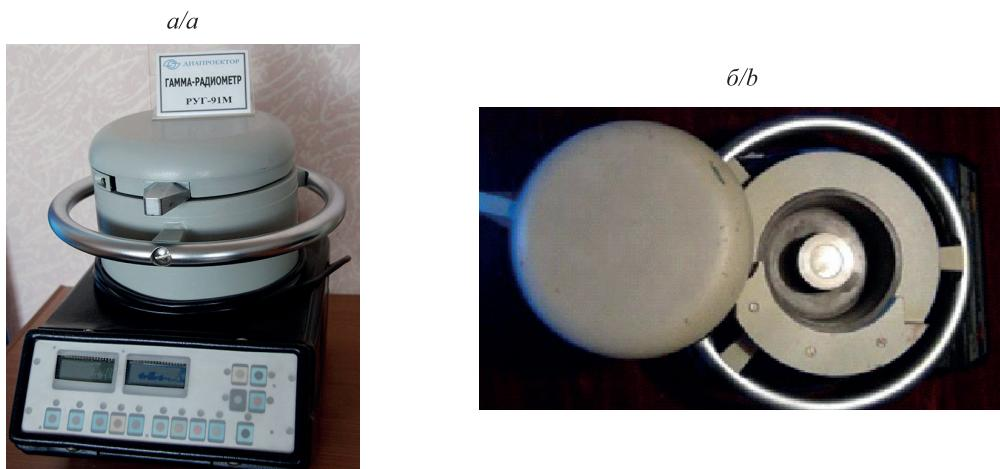
*Рис. 2. Общий вид гамма-радиометра РУГ-91М «Адани» (а)
