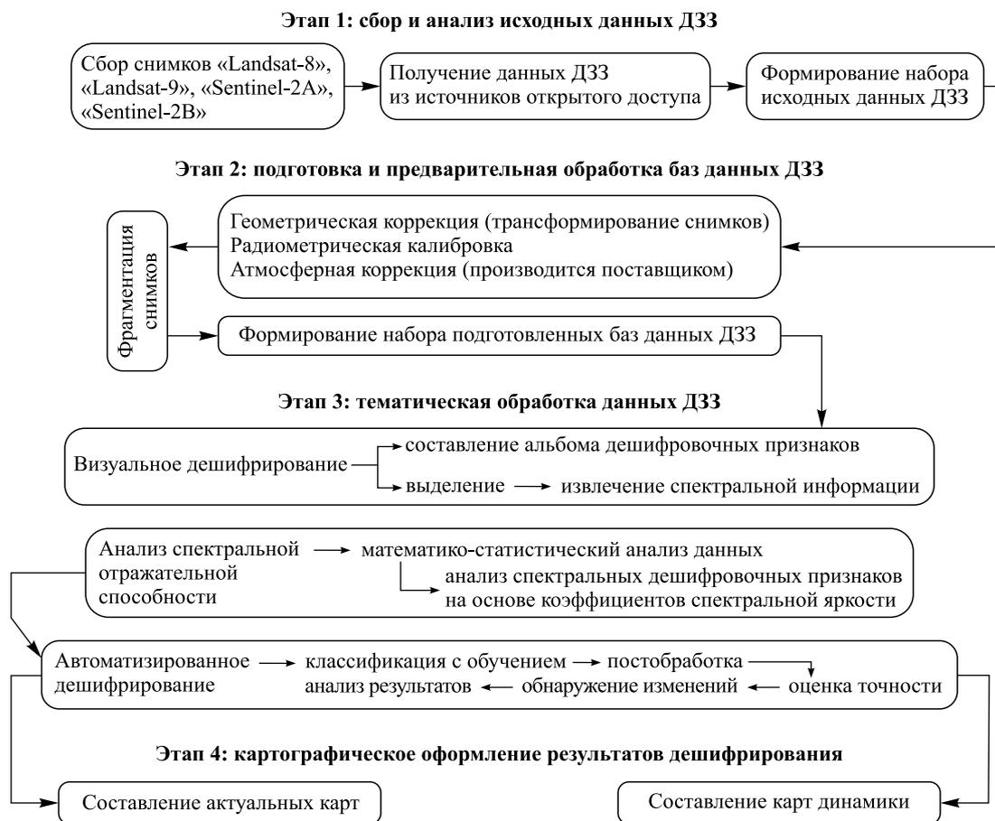
Рис. 2. Технологическая схема обработки данных ДЗЗ для картографирования лесной растительности
