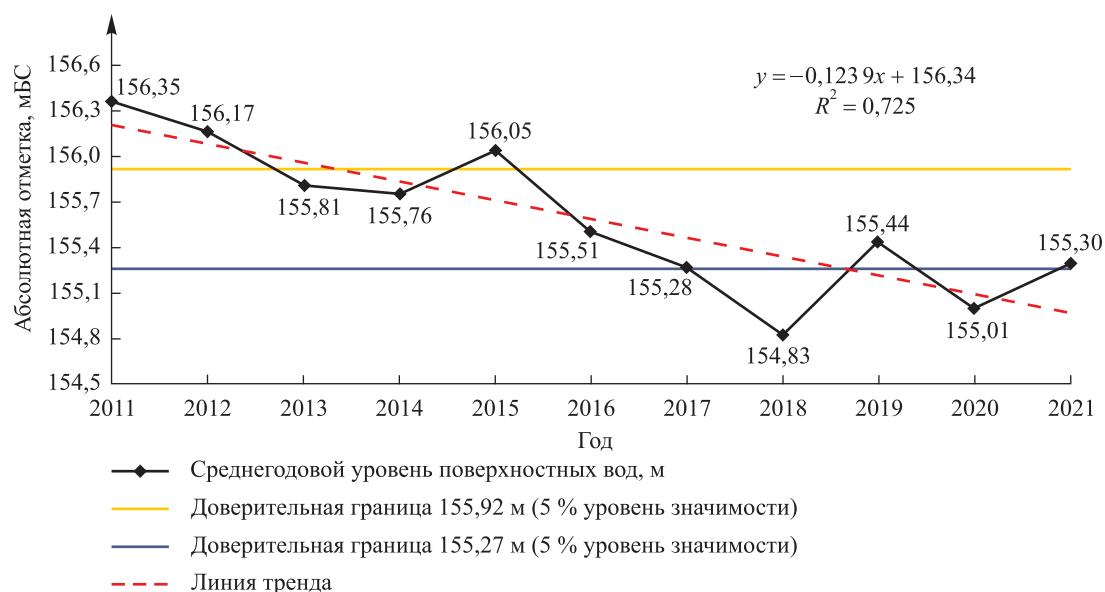
Рис. 4. График колебания среднегодовых уровней воды в пункте наблюдений мониторинга поверхностных вод ВП-3 (контрольном створе ниже карьера) по данным за 2011–2021 гг.
