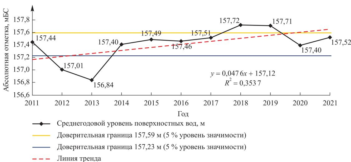
Рис. 2. График колебаний среднегодовых уровней воды в пункте наблюдений мониторинга поверхностных вод ВП-1 (компенсационном канале) по данным за 2011–2021 гг.
