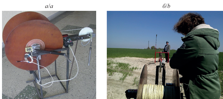
Рис. 2. Общий вид цифрового скважинного электротермометра (а) и процесс регистрации термограммы в скважине 966г, пробуренной в Солигорском районе Минской области (северо-западная часть Припятского прогиба) (б)
