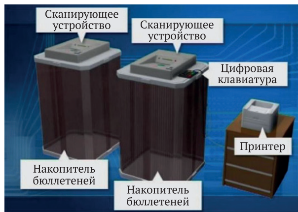
Рис. 1. Принцип работы КОИБ
