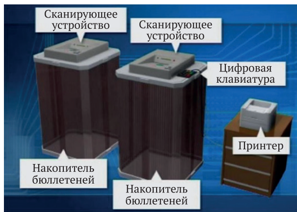
Рис. 1. Принцип работы КОИБ
